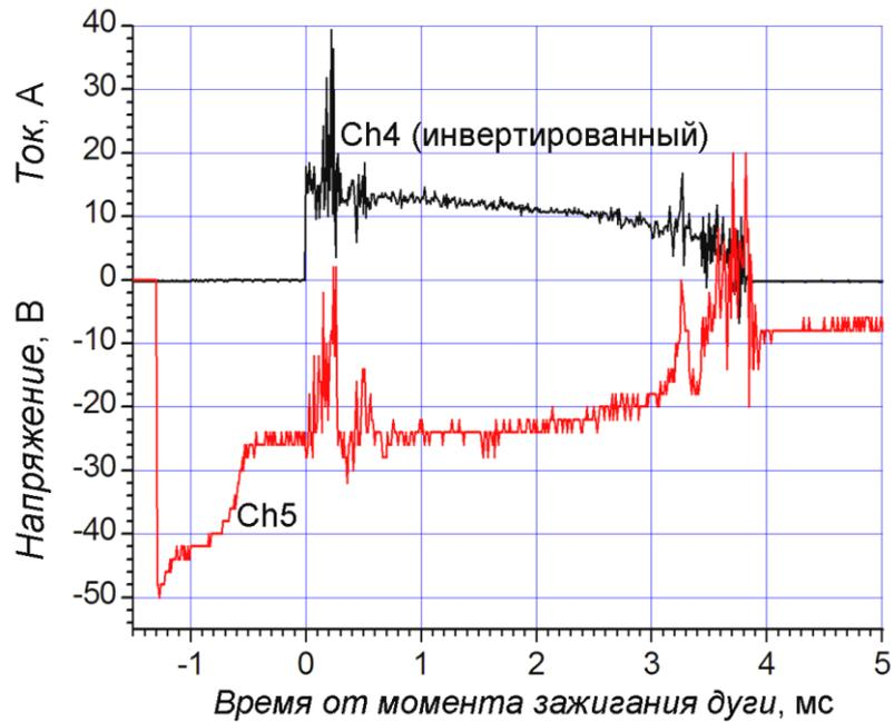
Рисунок 3.2 – Осциллограммы тока в цепи анода первичной дуги (Ch4) и напряжения на катоде первичной дуги (Ch5).
