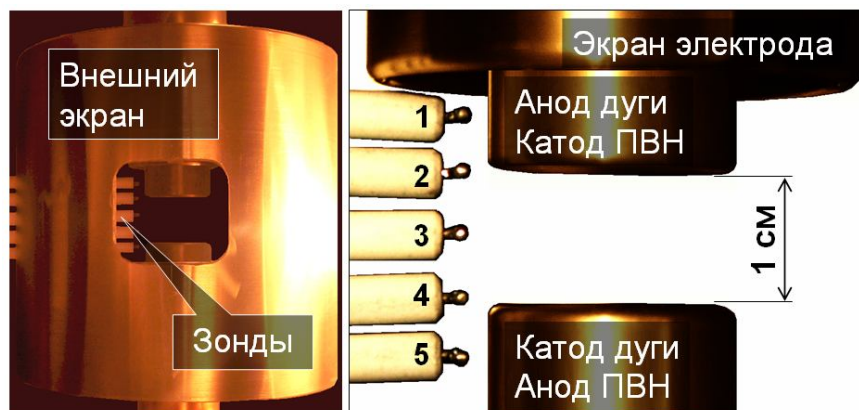
Рис. 3.9. Конфигурация электродов, зондов и экранов. Вид справа – увеличенный вид через окно внешнего экрана.
