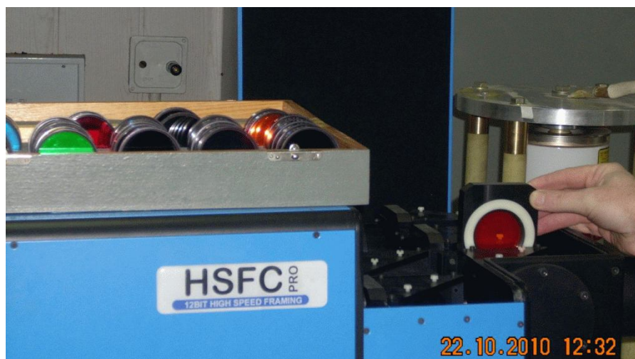
Рис. 3.13. Камера HSFC Pro с открытым делителем луча и набор интерференционных светофильтров, устанавливаемых в оптические тракты каналов камеры.
