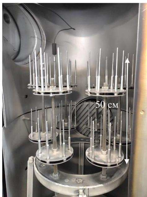
Рис.3 Азотированные пуансоны из стали Х12МФ в рабочей камере установки для генерации пучково-плазменных образований в несамостоятельном тлеющем разряде низкого давления с полым катодом
