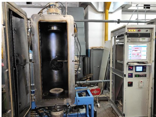
Рис. 2. Внешний вид камеры генератора пучково-плазменных образований
