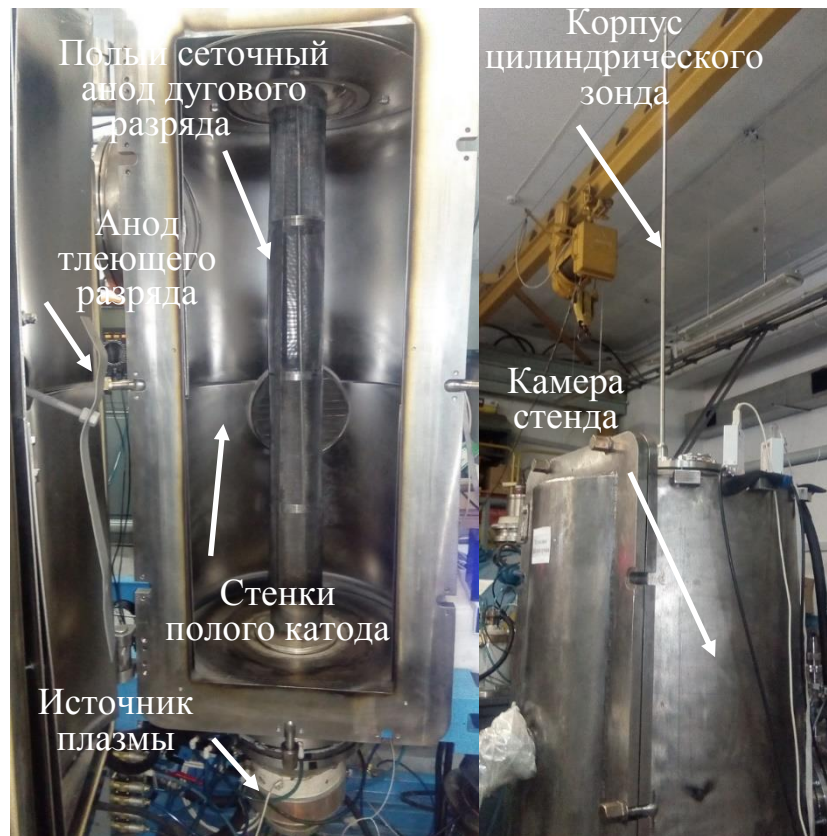
Рисунок 2. Вакуумная камера экспериментального стенда и одиночный цилиндрический зонд
