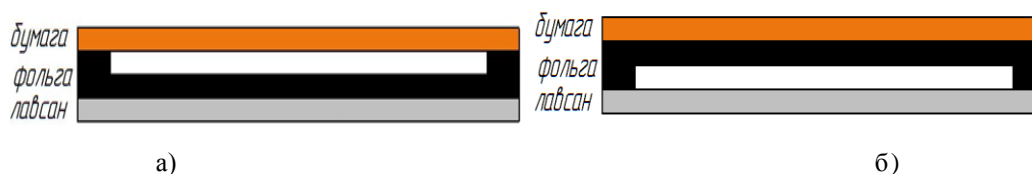
Рисунок 12. Ориентация загибов фольги: а) к бумаге (образец №7) и б) к пленке (образец №8).
