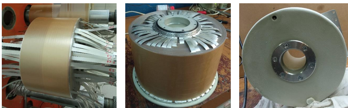
Рисунок 14. Фотографии цилиндрического конденсатора на этапе намотки, сборки и перед пропиткой
