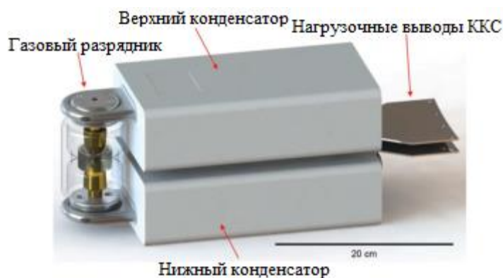
Рисунок 1. Внешний вид «брика», используемого в проектах Sandia National Laboratories, США. Начальный энергозапас до 800 Дж с максимальной пиковой мощностью до 5 ГВт [11].
