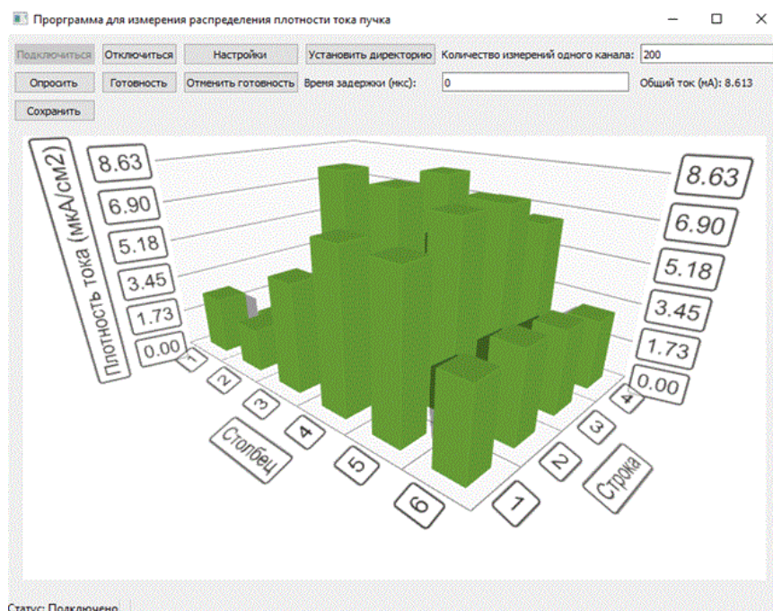
Рисунок 2.9 – Внешний вид главного окна программы для системы измерения распределения плотности тока электронного пучка
