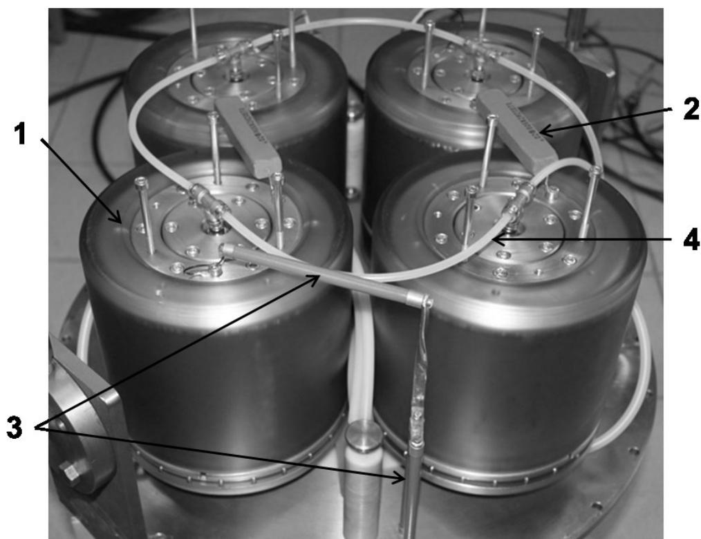
*Рис. 4.8. Выемная часть компактного сильноточного наносекундного генератора:
