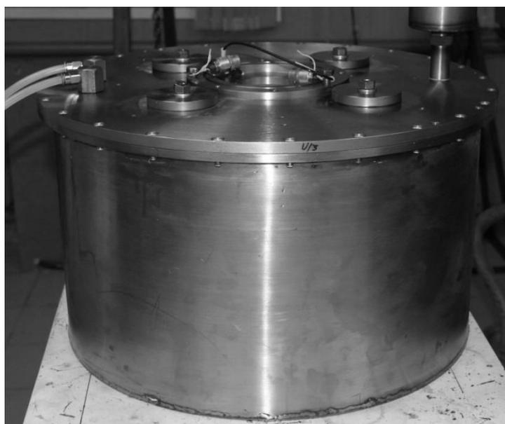
*Рис. 4.10. Фото компактного высоковольтного наносекундного генератора*
