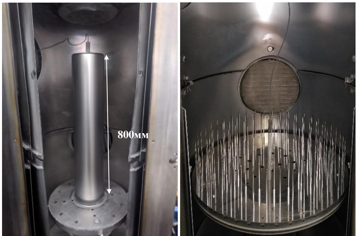
Рисунок 4.8 – Азотированные пуансоны из штамповых сталей в рабочей камере установки для генерации пучково-плазменных образований в несамостоятельном тлеющем разряде низкого давления с полым катодом
