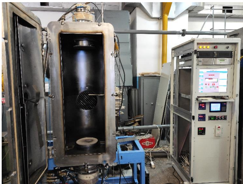
Рисунок 4.2 – Внешний вид генератора пучково-плазменных образований со стойкой управления
