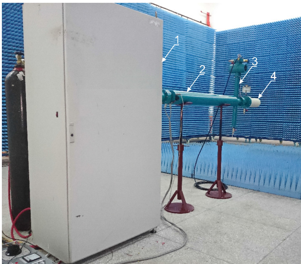
Рис. 4.33. Источник мощных радиоимпульсов со спиральной антенной: 1 — генератор СИНУС-160, 2 — нелинейная передающая линия, 3 — полосовой фильтр, 5 — спиральная антенна.
