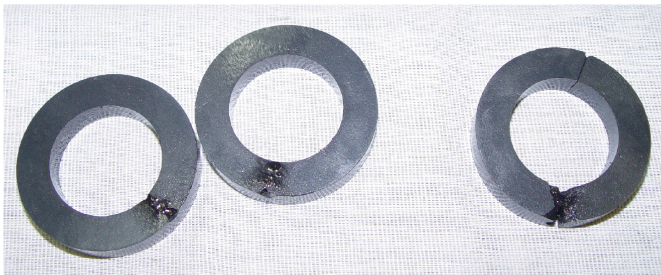
Рис. 4.1. Фотография после пробоя ферритовых колец с внешним и внутренним диаметром 45 и 28 мм.
