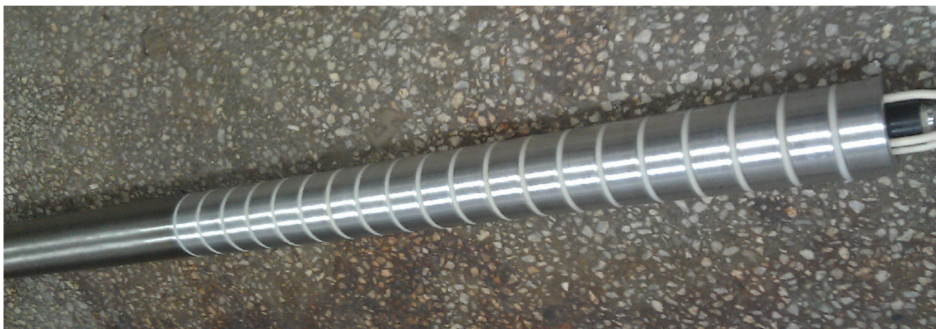
Рис. 2.48. Система металлических цилиндров с капролоновыми кольцами, одетых на ферритовую линию.
