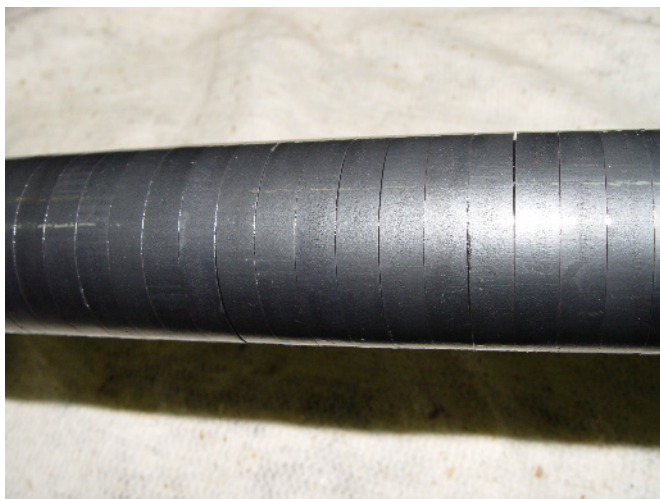
Рис. 4.8. Фотография ферритов на центральном проводнике по испытания на ресурс.
