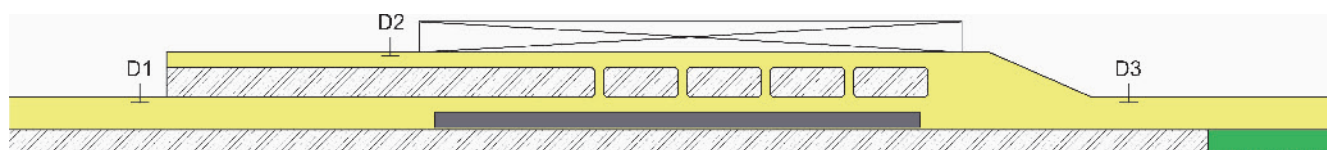
Рис. 2.47. Схематическое изображение геометрии связанных линий. Серым — феррит, желтым — вакуумное масло, зеленым — резистивная нагрузка. D1, D2, D3 — датчики напряжения.
