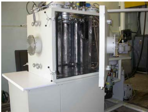
Рис. 8. Внешний вид вакуумной установки для ионно-плазменного нанесения а-С и а-С:Н покрытий.
