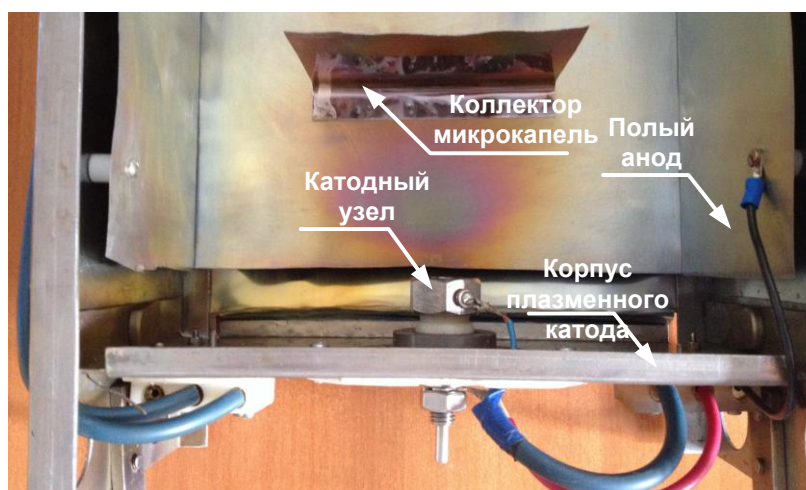
Рисунок 3.6 – Фотография плазменного катода с установленным коллектором для микрокапель от нового катодного узла с инициированием катодного пятна электрическим пробоем в газе
