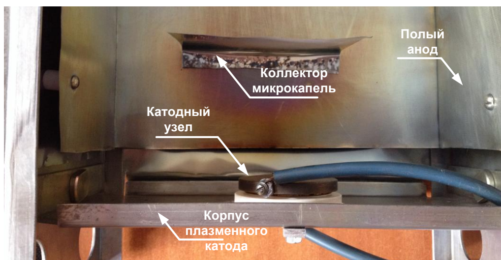
Рисунок 3.1 – Фотография плазменного катода с установленным коллектором для микрокапель от катодного узла с инициированием катодного пятна электрическим пробоем по поверхности диэлектрика
