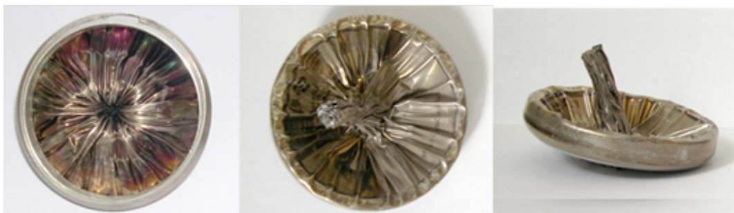
Рис. 3. Внешний вид цилиндра с начальным диаметром 66 мм после срабатывания затвора.
